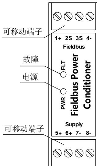
图 2.2 总线电源面板示意图
