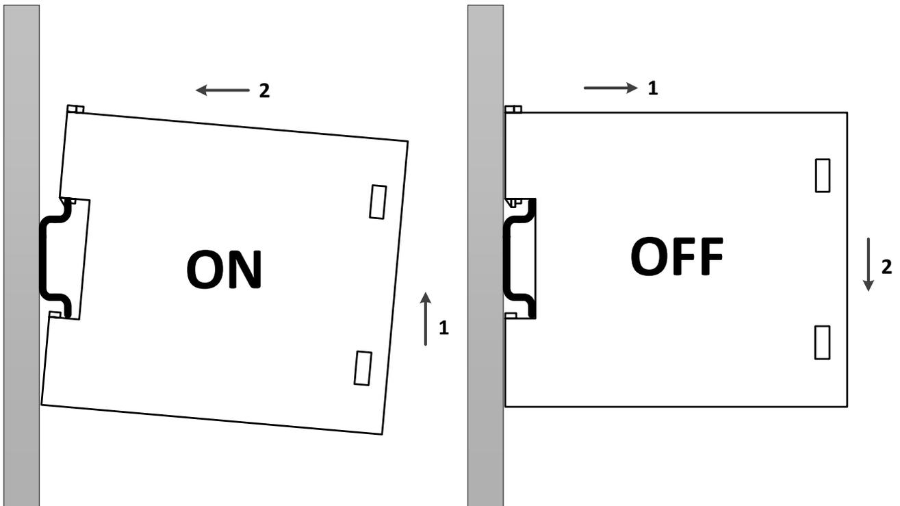
图 2.1 总线电源与总线终端 DIN 导轨安装示意图
