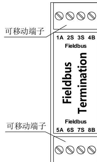
图 2.3 总线终端面板示意图
