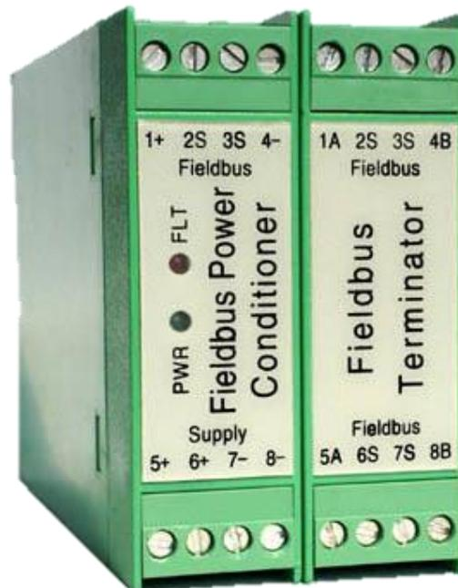
图 1.1 总线电源与总线终端
