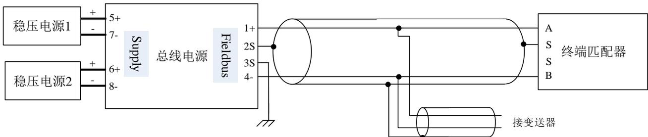
图 3.1 总线电源连接（注：总线电源内置终端匹配器有效）
