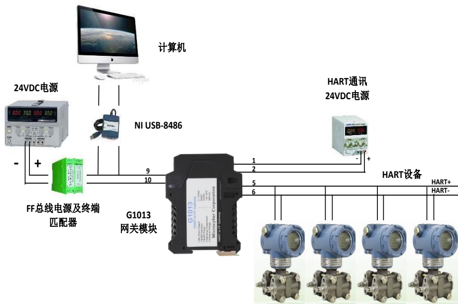
图 3.1 HART 到 FF 网关模块系统连接图
